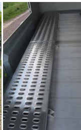
Auffahrtschiene Roadster 800 - Länge 3600 mm Roadster 900 - Länge 4500 mm
